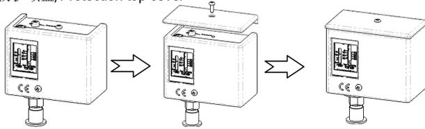
标准产品防护等级为 IP30, 可使用产品定制的三花防护顶盖附件 (需额外采购) 安装, 可达到防护等级 IP44, 拆下顶盖时, 防护等级 IP30;
