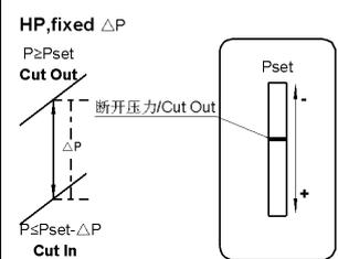
断开压力-接通压力=压差
