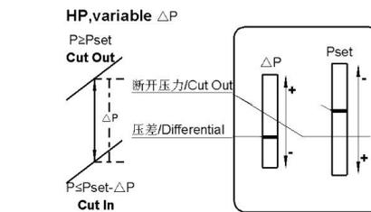
断开压力-接通压力=压差
