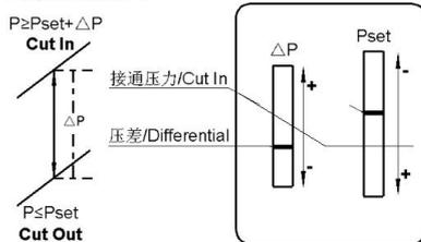
接通压力-断开压力=压差
